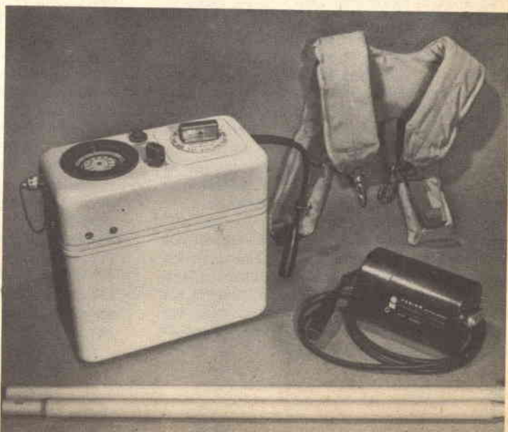
Fig. 1 - Il magnetometro a libera precessione di protoni, costruito dalla Varian, può essere usato a terra o sott'acqua con la testa sensibile, visibile a destra, racchiusa in un contenitore impermeabile.
